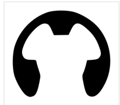
Sicherungsring nach DIN 6799, die aufgrund einer gewissen Ähnlichkeit mit dem Buchstaben "E" bzw. "e" auch als "E-Ring" bezeichnet wird.
