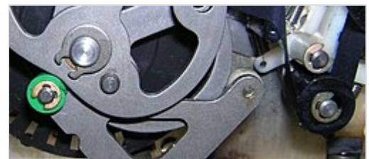
Maschinenteil mit vier Außen-Sicherungsringen. Die messingfarbenen, aufklipsbaren Sicherungsscheiben werden im Handel oft als E-Ring bezeichnet.
