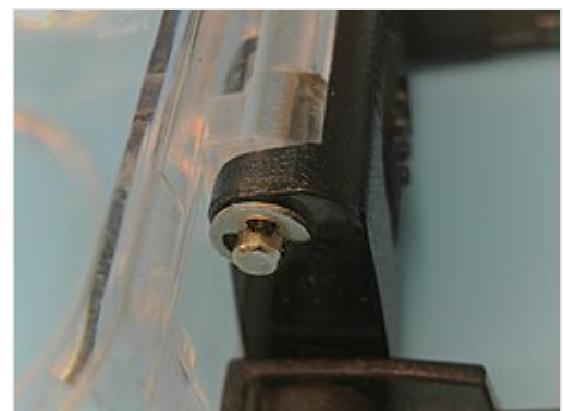
E-Ring auf der Achse eines Action-Cam-Gehäuses
